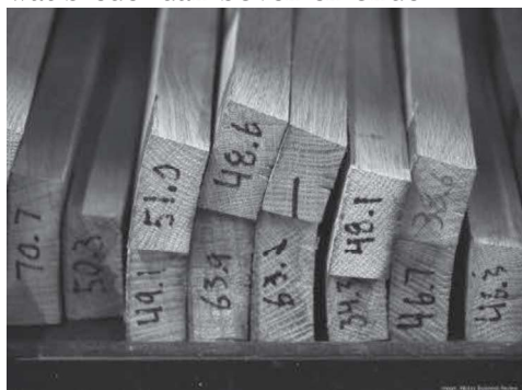
Hierboven worden bij de Adirondack cooperage in Remsen, New York de balkjes uitgezocht; hiernaast de kant en klare duigen, op breedte gesorteerd
