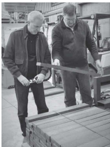
Hierboven worden bij de Adirondack cooperage in Remsen, New York de balkjes uitgezocht; hiernaast de kant en klare duigen, op breedte gesorteerd
