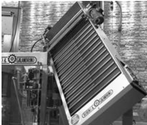
Een onderdeel van de bottellijn: dit apparaat brengt de korfjes op de champagnekurken aan. Italiaans.
